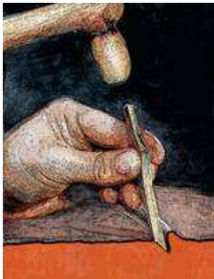
Einschlagen der Tauschiergruben mit einem Bronzemeißel (© LDA Sachsen-Anhalt)
