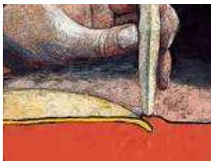
Zutreiben der Tauschiergruben und Festklemmen des Goldbleches (© LDA Sachsen-Anhalt)
